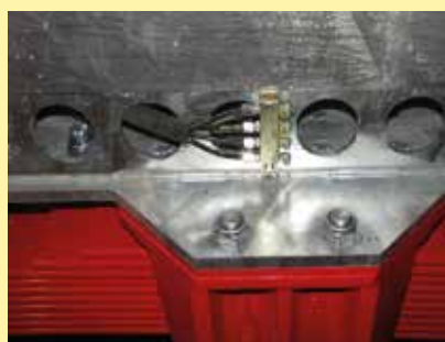
Zentralschmierung mit Schmierleiste (auch mit autom. Zentralschmierung ausrüstbar)
