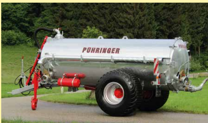
Einachs-Vakuumfass mit Y-Deichsel und Untenanhängung
