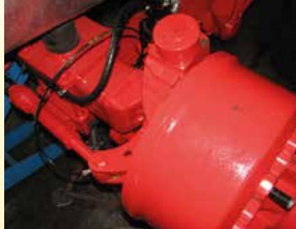
Gefedertes Boogieaggregat mit hydraulischer Nachlauf- oder Zwangslenkung und Zentralschmierung
