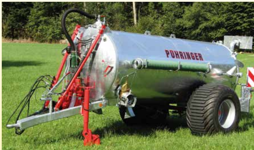
Vakuumfass mit Untenanhängung u. Radkästen
