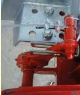
Achsverstellung für Schleppschlauchsystem
