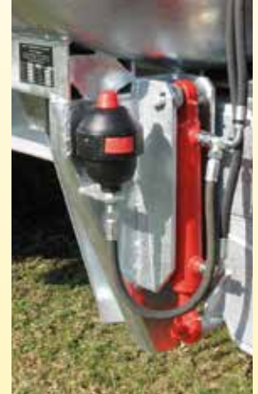
Hydr. Deichselfederung mit Gasdruckdämpfer bzw. hydr. Talausbringung
