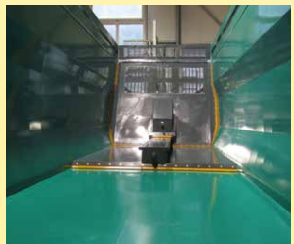
Wannenkonstruktion mit Schiebewand
