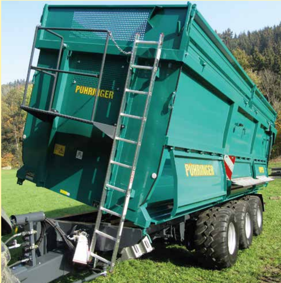
Tridem mit seitlich hydr. Bordwandöffnung
